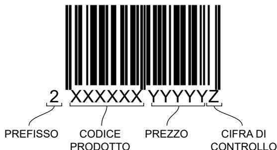
Il barcode EAN13 viene calcolato ed emesso dalla bilancia prezzatrice (non in dotazione) dopo aver pesato l'articolo. La vendita si effettua tramite l'utilizzo di un lettore barcode (o lettore codici a barre, non in dotazione). Il riconoscimento del codice PLU si esegue, avvicinando il lettore barcode al barcode (o codice a barre) dell'articolo.
